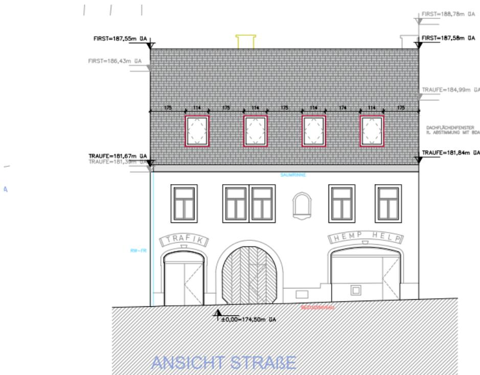
Abbildung 19: ÄP 19, Auszug aus dem Vorabzug zum geplanten Dachgeschoßausbau, Straßenansicht, Quelle: BERGER LENZ Architekten ZT GmbH, Projektnummer 0408-1, Plannummer 201-1 vom 01.02.2024)
