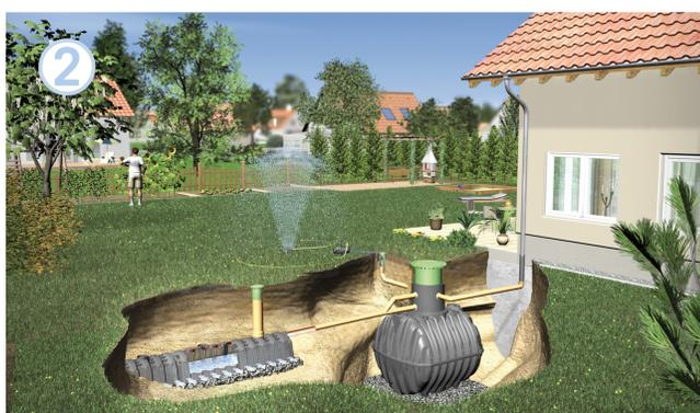
ABBILDUNG REGENWASSERSPEICHER (QUELLE: SCHÜTTER BEHÄLTERCENTER)
